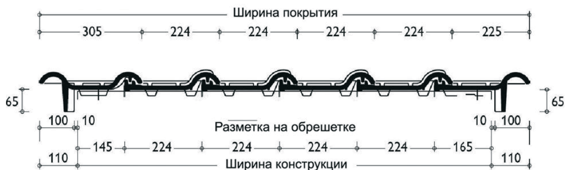
Рис. 7. Продольный разрез кровли с применением на фронте боковой черепицы (левой и правой).
