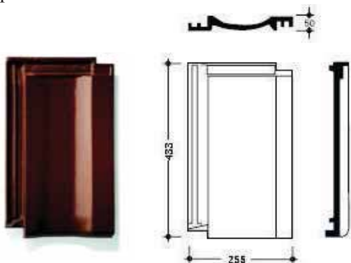
Рис. 14. План черепицы, поперечный и продольный разрезы.
