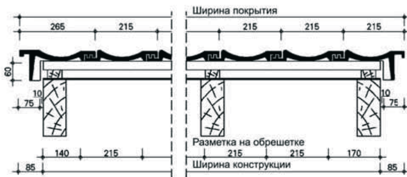
Рис. 16. Продольный разрез кровли с применением на фронте боковой черепицы (левой и правой)
