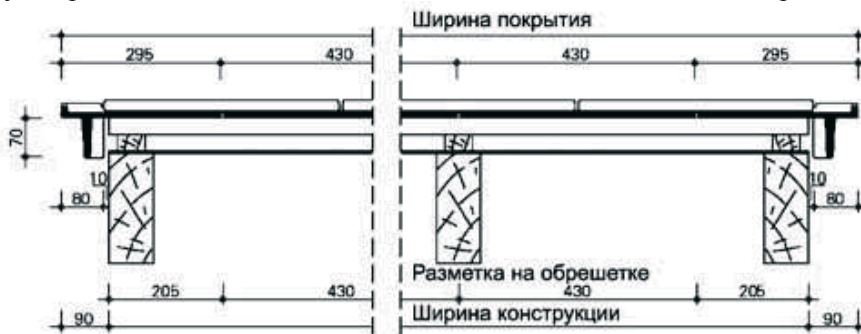
Рис. 22. Продольный разрез кровли с применением на фронте боковой черепицы (левой и правой)
