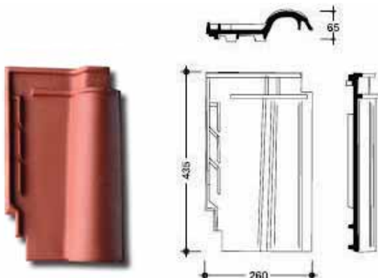
Рис. 23. План черепицы, поперечный и продольный разрезы.
