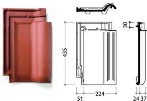
Рис.5. План черепицы, поперечный и продольный разрезы. Рекомендуемый уклон кровли – от 22°; Вес черепицы ~ 3,2 кг.; Расход на 1 м 2 ~ 12,9 шт.; Средняя длина черепицы в кровле ~330- 360 мм (см. рис. 6); Средняя ширина черепицы в кровле ~ 224 мм (см. рис. 7);
