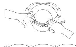
Вырежьте строго по контуру отверстие в металлочерепице лобзиком либо ножницами.
