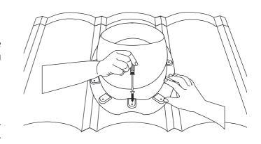
Закрепите саморезами все оставшиеся отверстия, если профиль имеет сильное отклонение от базового профиля, используйте дополнительные клипсы до плотного прижатия проходного элемента к металлочерепице.
