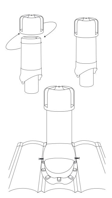
Установите трубу с колпаком в проходной элемент и выставите трубу в вертикальное положение по уровню земли, который находится на копаке.
