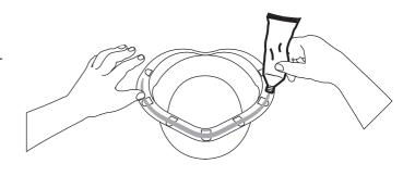
Установите проходной элемент и закрепите саморезами верхний край и нижний края через клипсы.
